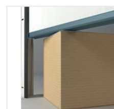
Protection si un obstacle est détectée, la porte s'arrête et remonte
